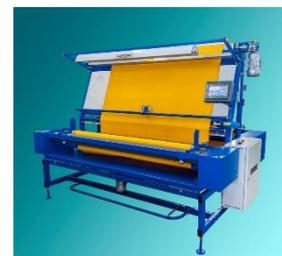
Машина обеспечивает перемотку рулонов ткани диаметром **до 400 мм и весом до 60 кг**. Выпускается на ширину рулона 1800 мм / 2000 мм / 2500 мм / 3200 мм / 3500 мм. Стандартно оснащена **системой выравнивания кромки рулона.**
