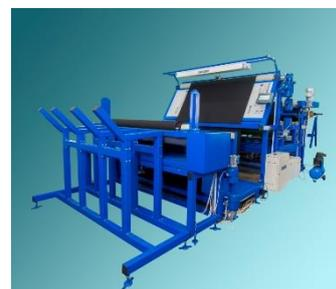
Мерильно-браковочная машина для трикотажа В02.18 обеспечивает перемотку рулонов материала **с контактной телеги диаметром до 1500 мм и весом до 500 кг в товарные рулоны диаметром до 800 мм и весом до 100 кг.** Машина стандартно оснащена **системой выравнивания кромки рулона и системой транспортерных лент** для деликатного перемещения материала и **дополнительной релаксации полотна.**
