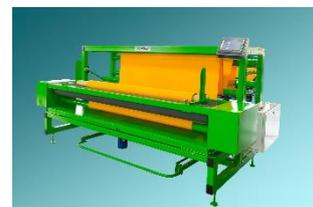
Скорость перемотки машины совмещается с линией и регулируется от 0 до 10 м/мин. Намоточный станок оснащен счетчиком метража, системой регулировки плотности наматываемого рулона и функцией выравнивания края в процессе намотки.
