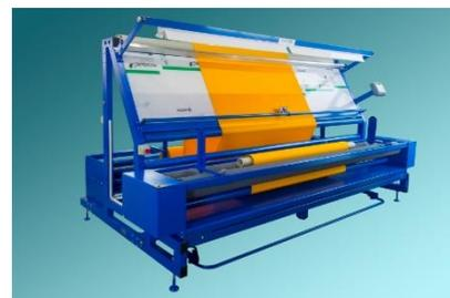
Машина обеспечивает перемотку рулонов **диаметром до 600 мм и массой до 200 кг.** Выпускается на ширину рулона 1800 мм / 2000 мм / 2500 мм / 3200 мм / 3500 мм. Стандартно оснащена **системой выравнивания кромки рулона.**
