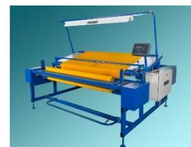
Машина мерильно-браковочная модели В01.14 предназначена для перемотки из рулона в рулон, измерения метража и контроля качества неэластичных и слегка эластичных материалов.
