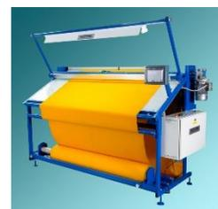
Машина А02.4 работает с рулонами ткани **диаметром до 400 мм и массой до 50 кг**. Выпускается на ширину рулона 1800 мм и 2000 мм.
